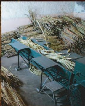
**Molienda:** La caña de azúcar es clasificada para su molienda por orden de llegada, reduciendo así al máximo, el tiempo transcurrido entre el corte de la caña y la extracción del jugo o "guarapo". El residuo obtenido en la molienda, el "bagazo", es recuperado por los cosecheros de la zona y utilizado como fuente de abonado natural para la agricultura local.
